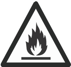
Cet appareil utilise un réfrigérant inflammable.
