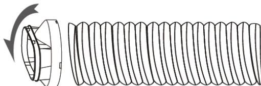
**Passo 3:** Estendere il kit regolabile secondo la lunghezza della propria finestra. Collegare il tubo di scarico al kit per finestre.
