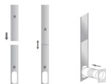
**Schritt 4:** Schliessen Sie das Fenster, um den Fensterschiebersatz anzubringen. Der Fensterschiebersatz muss festgehalten und ggf. mit Klebeband gesichert werden. Für maximale Effizienz wird empfohlen, die Lücke zwischen dem Adapter und der Seite des Fensters abzudichten.
