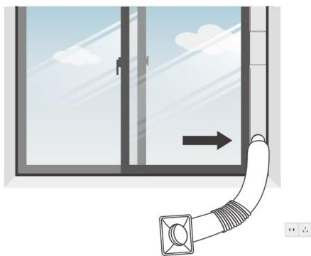
**Passo 5:** Collegare il connettore del tubo allo scarico dell'aria dell'unità.
