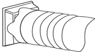
**Schritt 2:** Verbinden Sie den Fenster-Adapter mit dem anderen Ende des Abluftschlauchs.
