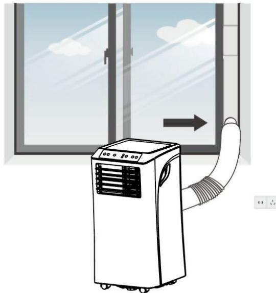
**Passo 7:** Regolare il deflettore sul foro di uscita dell'aria e accendere l'unità.
