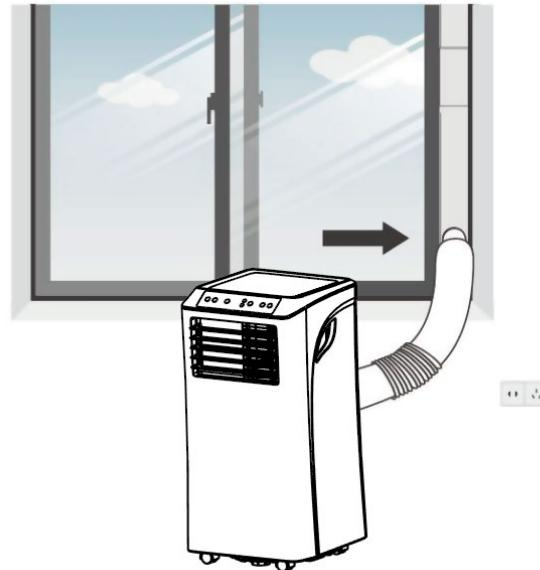
**Etape 7 :** Ajustez les ailettes de la sortie d'air. Insérez la fiche secteur dans la prise et allumez l'appareil.
