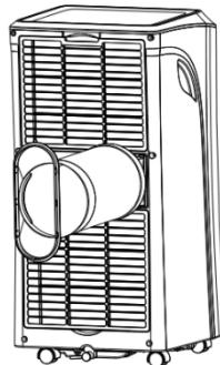
**Passo 6:** Regolare la lunghezza del tubo di scarico flessibile ed evitare di piegare il tubo. In seguito, posizionare il condizionatore vicino a una presa di corrente.
