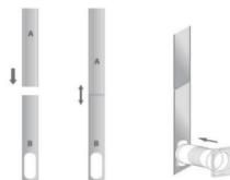
**Etape 4 :** Fermez la fenêtre pour installer le jeu de glissières pour fenêtre. Le jeu de glissières pour fenêtre doit tenir en position et être au besoin fixé par ruban adhésif. Pour une efficacité maximale, il est recommandé d'obturer de manière étanche d'éventuels intervalles entre l'adaptateur et le côté de la fenêtre.
