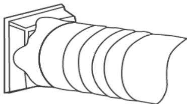
**Passo 2:** Collegare l'adattatore del kit per finestre all'altra estremità del tubo di scarico.
