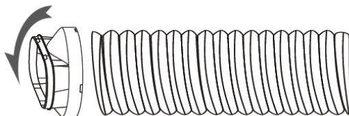
**Etape 3 :** Ajustez la longueur du tuyau d'évacuation d'air réglable à votre fenêtre. Plus le tuyau est court, plus l'effet de refroidissement est élevé. Raccordez le tuyau d'évacuation d'air au jeu de glissières pour fenêtre.
