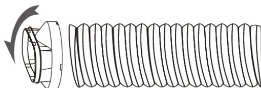
**Schritt 3:** Verändern Sie die Länge des verstellbaren Abluftschlauchs zu Ihrem Fenster. Je kürzer der Schlauch, desto höher die Kühlwirkung. Verbinden Sie den Abluftschlauch mit dem Fensterschiebersatz.
