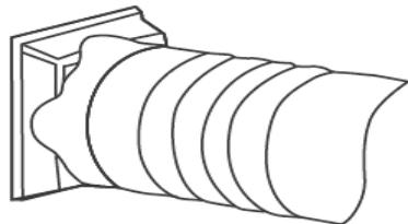
**Etape 2 :** Connectez l'adaptateur pour fenêtre à l'extrémité opposée du tuyau d'échappement.
